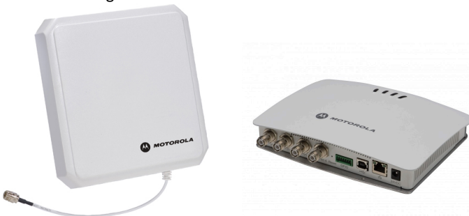
Figura 14 – Antena UHF e Leitor RFID
