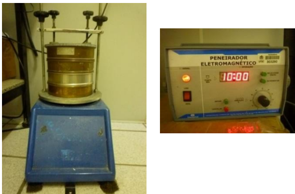
Figura 13. Peneirador eletromagnético utilizado no processo de pré-tratamento
