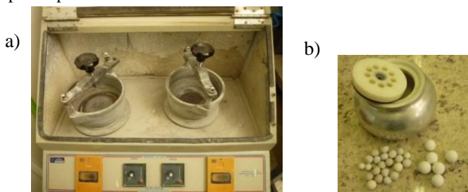
Figura 12. a) Moinho planetário utilizado para a moenda das conchas; b) Recipiente para a moenda
