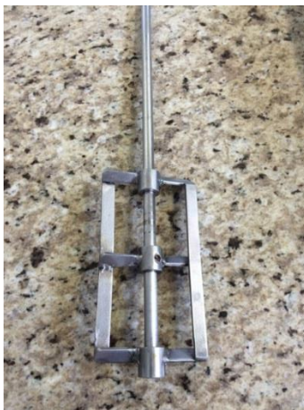
Figura 23- Impelidor tipo ancora utilizado pela empresa. Fonte: desenvolvida pelo autor.
