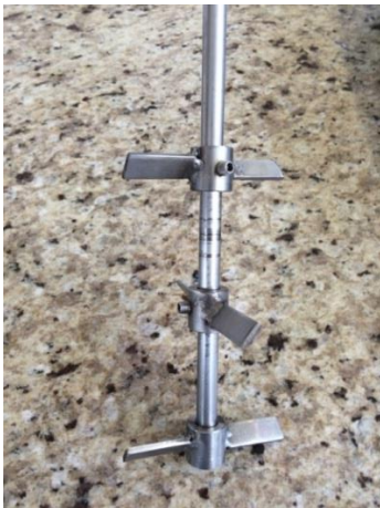
Figura 24 - Impelidor tipo pá reta inclinada - modelo proposto. Fonte: desenvolvida pelo autor.
