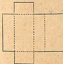
Fig. 519. — Desenvolvimento do prisma quadrangular.
