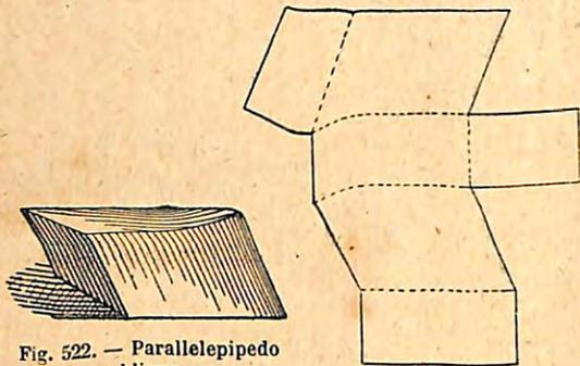
Fig. 522. — Paralelepipedo obliquo.
