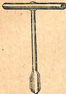
Fig. 64. — Um trado : duas linhas perpendiculares entre si.
