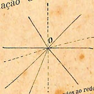
Fig. 49. — Angulos formados ao redor de um ponto equivalem a quatro angulos rectos.
