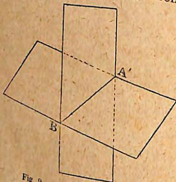
Fig. 9. — Recta AB; intersecção de duas superficies : uma linha.
