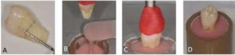
Figura 2- (A) Medição da JAC. (B) Dispositivos de montagem contendo resina acrílica. (C) Inclusão das amostras nos dispositivos. (D) Espécime montado.
