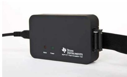
Figura 5.22: Emulador de flash da Texas Instruments.
