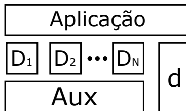
Figura 4.12: Arquitetura proposta para o software embarcado do Tau.
