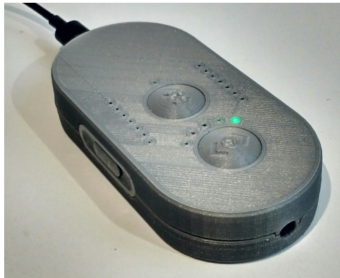
Figura 5.11: Protótipo final do Tau dentro da carcaça fabricada em impressora 3D.
