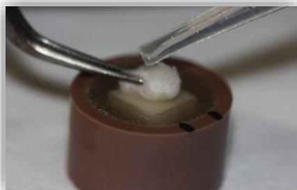
Figura 5: Condicionamento da superfície com monômero de metilmetacrilato (MMA) (Alike, GC America Inc.) por 180 segundos.
