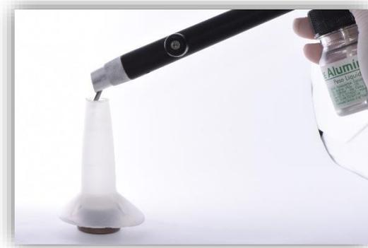
Figura 4: Jateamento com óxido de Alumínio e matriz de 6 centímetros para a padronização da distância do jateamento.
