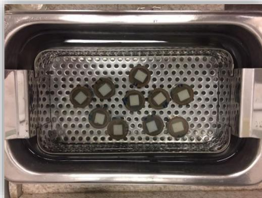
Figura 3: Blocos submetidos ao banho ultrassônico.
