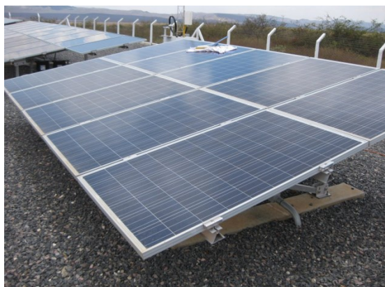
Figura 38 - Comparação entre módulos FV sujos e limpos do sistema p-Si. A pequena concentração de sujeira neste subsistema é percebida pela semelhança visual dos módulos FV limpos e sujos.
