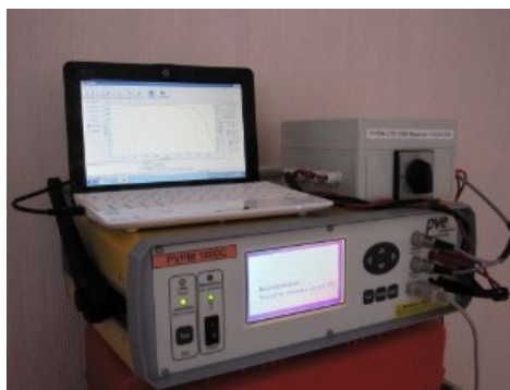
Figura 24 – Traçador de curvas IxV utilizado – PVPM 1000C
