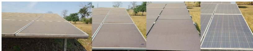
Figura 52 – Perfil de sujeira para cada tecnologia (da esquerda para direita, a-Si/ \mu c-Si, a-Si com moldura, a-Si sem moldura e p-Si).
