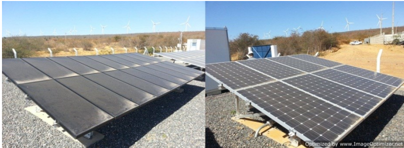
Figura 32 – Subsistemas CIGS (esquerda e a barlavento), apresentando maior concentração de sujeira, frente ao subsistema m-Si (direita e a sotavento).
