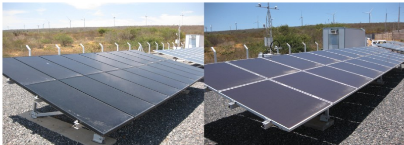
Figura 37 – Perfil de acúmulo de sujeira dos subsistemas CIGS (esquerda) e a-Si (direita).
