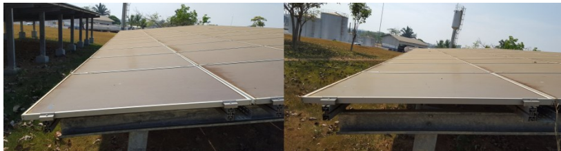
Figura 44 – Subsistemas a-Si (esquerda) e a-Si/ \mu c-Si (direita), mostrando o perfil de sujeira aderida.
