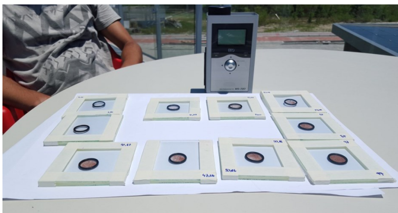
Figura 23 – Instrumento (espectroradiômetro) utilizado na avaliação das diferentes concentrações de sujeira.
