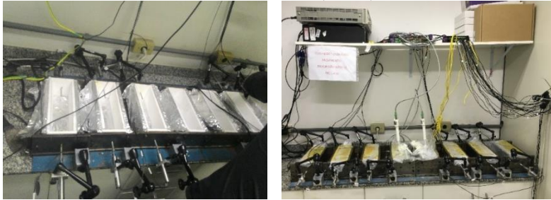
Figura 37: Vista geral da banca de retração pronta para usar (esquerda), com ensaio em andamento (direita).
