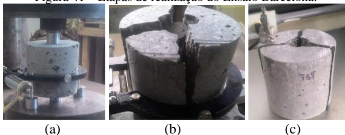
Figura 41 – Etapas de realização do Ensaio Barcelona.
