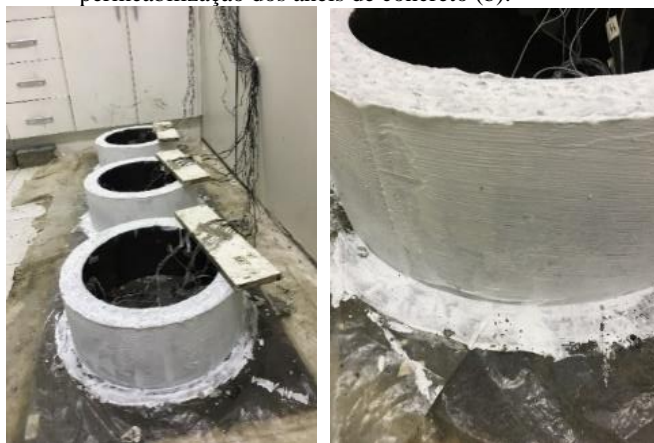
Figura 40: Ensaio de retração autógena restringida (a) e detalhe da impermeabilização dos anéis de concreto (b).
