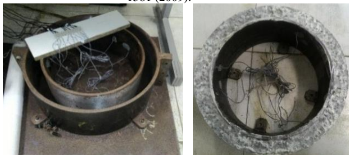
Figura 38 - Aparato para ensaio de retração restringida de acordo com a ASTM 1581 (2009).
