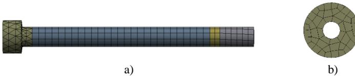
Figura 35 – Malha em elementos finitos do parafuso e da arruela, em a) e b), respectivamente.
