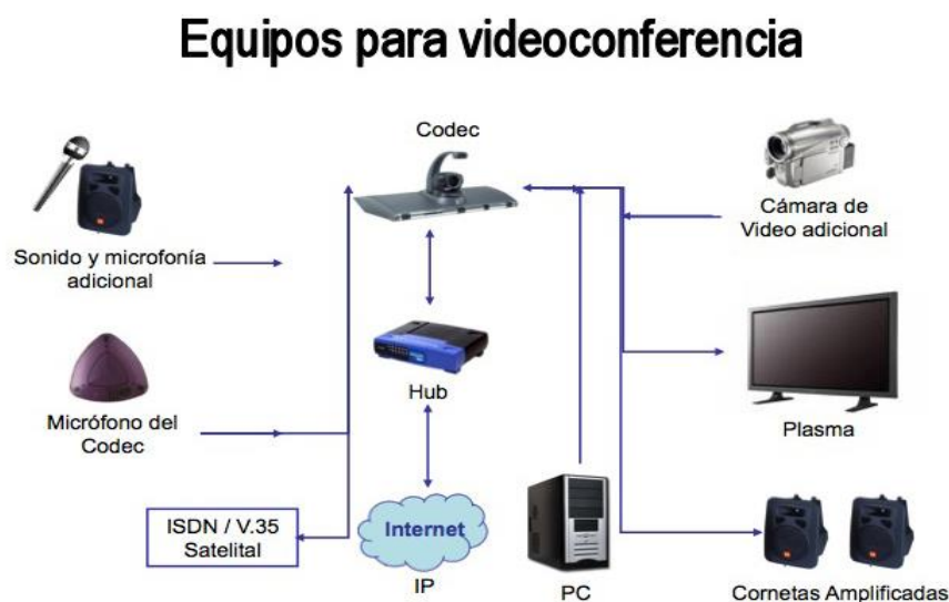
Figura 6: Diagrama esquemático de equipamentos utilizados em um sistema de videoconferência.
