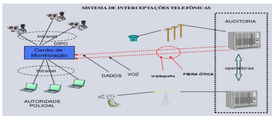
Figura 13: Diagrama esquemático de um Sistema de Interceptação Telefônica.
