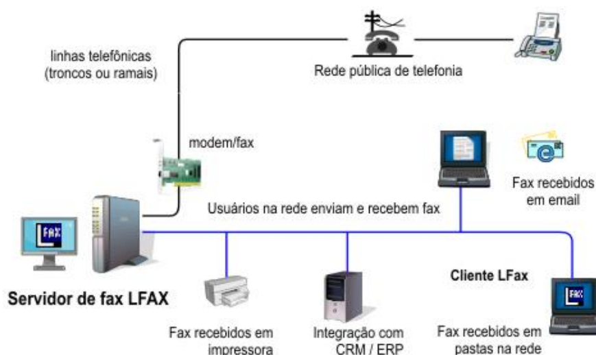
Figura 7: Diagrama esquemático de um software para transmissão e recepção de fax.
