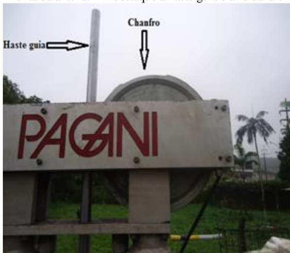
Figura 22 – Ponta da antena. Em destaque a haste guia e a roldana chanfrada.
