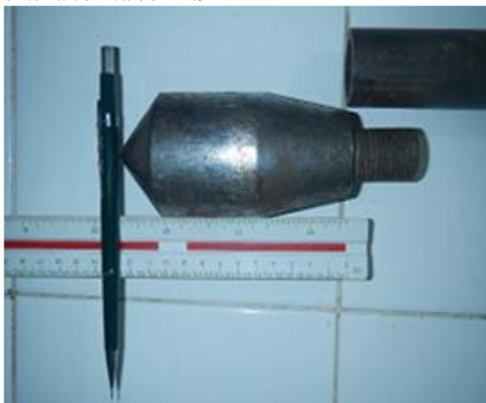
Figura 16 - Ponteira cônica do DPSH
