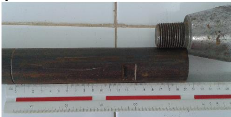
Figura 17 – Haste do DPSH , com medidas indicadas de 20 cm.
