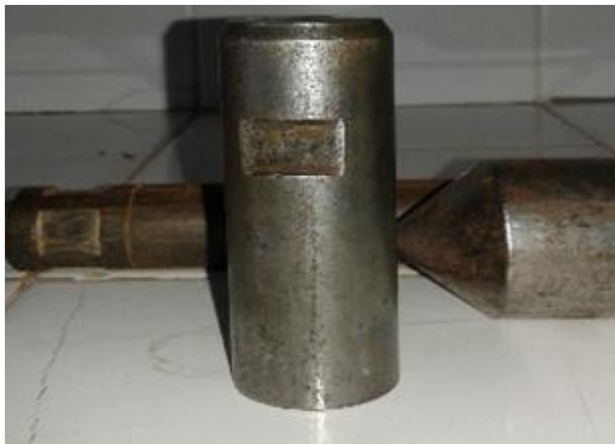
Figura 19- Cabeça de bater. Observa-se o chanfro para conexão de chave de Chave de boca.
