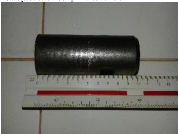
Figura 18 - Cabeça de bater. Comprimento de 10 cm.
