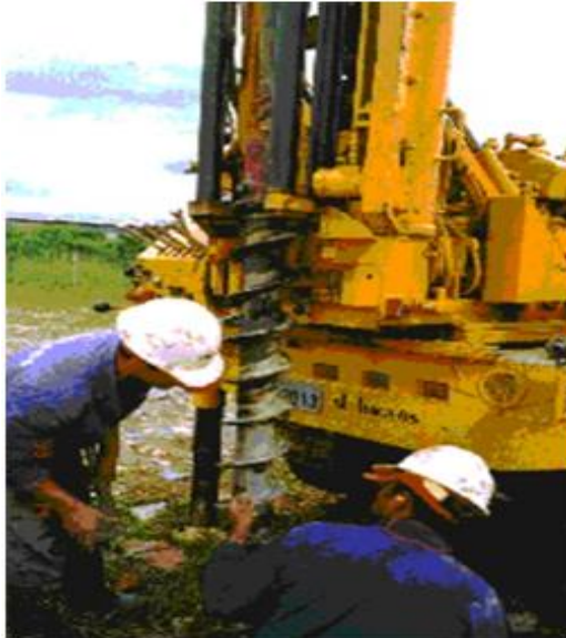
Figura 3 - Detalhe do trado helicoidal em equipamento SPT mecanizado.
