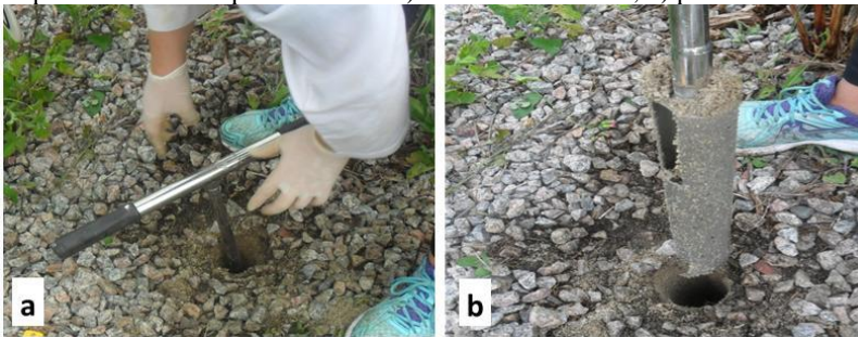
Figura 10 – Coletas de amostras do maciço filtrante do wetland em diferentes profundidades do perfil vertical. a) amostrador de solo; b) perfil coletado.
