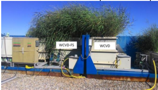
Figura 15 – Wetland construído vertical descendente de fundo saturado e wetland construído vertical descendente do procedimento experimental III.
