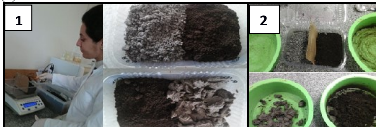
Figura 3 - Ensaio de fuga com E. andrei : Preenchimento dos recipientes com solo-teste e solo-controle (1) e leitura do ensaio (2).
