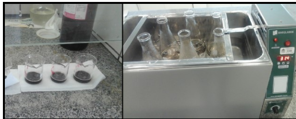
Figura 1 - Mistura ácido sulfúrico e amostra do resíduo e erlenmeyers com as misturas (ácido/amostra) e água destilada em banho maria.
