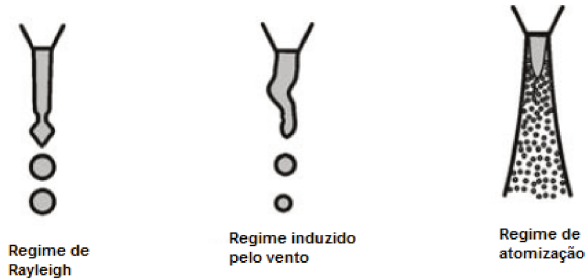
Figura 2-14 - Descrição esquemática dos regimes de quebra de jato (Adaptado de BAUMGARTEN, 2006)
