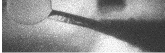
Figura 2-16 - Efeito da cavitação assimétrica dentro do furo do bico injetor (BAUMGARTEN, 2006)
