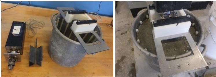
Iniciava-se o teste para a determinação da tensão de escoamento estática pelo método *stress growth test*, no qual o perfil vane é rotacionado a uma velocidade lenta e constante de 0,025 rps. O aumento do torque é medido em função do tempo. O torque máximo obtido durante o teste é usado para calcular a tensão de escoamento estática (SAAK; JENNING; SHAH, 2001). A Figura 52 mostra um gráfico típico para a determinação da tensão de escoamento estática.
