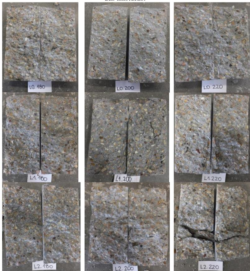
Figura F2: Concretos com fíler diabásico - verificação da ausência de segregação das misturas.
