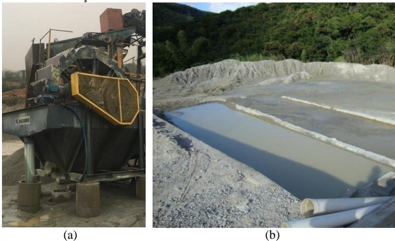
Figura 22: Descarte do fíler de britagem em pedreiras: processo de retirada do fíler por via seca.
