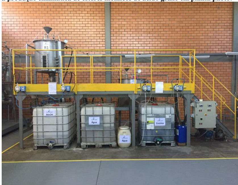
Figura 3.1- Plataforma metálica com a unidade experimental montada para a produção enzimática de ésteres metílicos de ácido graxo em planta piloto.
