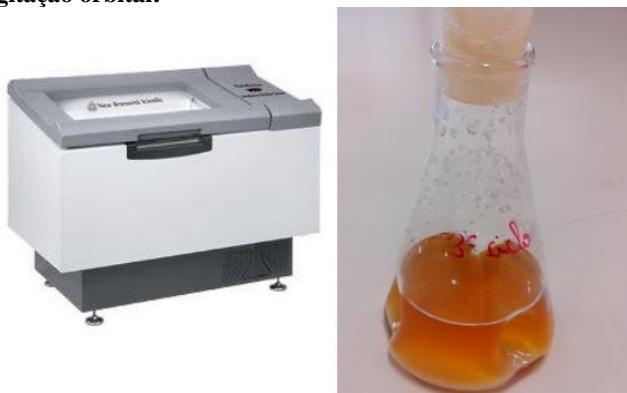
Figura 2.2- Unidade experimental utilizada na produção de ésteres metílicos utilizando a lipase Eversa® Transform por meio de erlemeyer aletado de 250 ml e agitação orbital.
