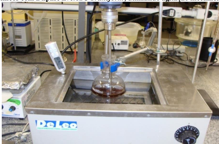
Figura 2.1- Unidade experimental montada para a produção de ésteres metílicos com a lipase Eversa® Transform , utilizando agitação mecânica.
