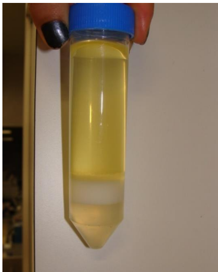
Figura 2.4- Visualização do sistema trifásico após a centrifugação do volume reacional.
