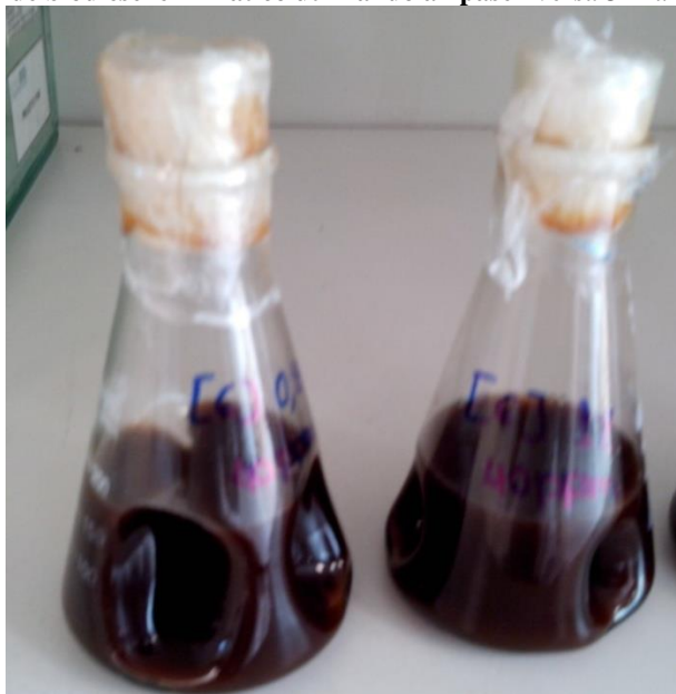
Figura 2.13 - Aspecto visual do óleo ácido residual estudado nas reações de produção de biodiesel enzimático utilizando a lipase Eversa® Transform .
