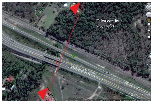
Figura 199: Ampliação rodovia A1 em Stony Creek. Cruzamento de fluxo de pessoas, fauna, estrada de ferro e rodovia. Passagens em níveis diferentes; fauna e pessoas, inferior.
