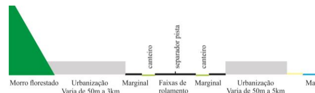
Figura 368: Padrão BR-101/SC na Grande Florianópolis. Área conurbada: a rodovia segue o mesmo padrão: na planície com urbanização nas bordas, limitada pela costa e pelos morros. Barreira de concreto para dividir pistas e canteiros laterais separando faixas de rolamento das vias marginais. As pistas encontram-se no nível da urbanização, exceto no acesso para vias marginais e viadutos. Fonte: Angela Favaretto, 2017.
