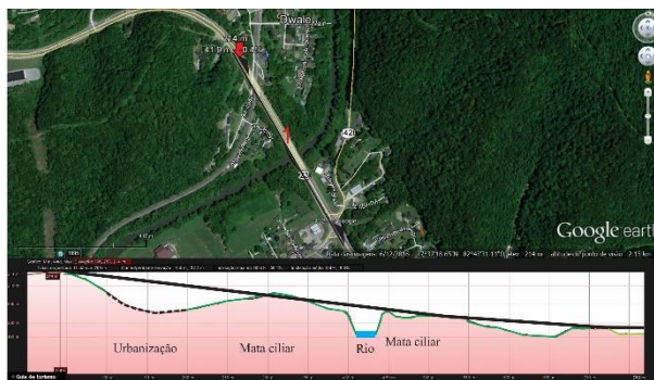
Figura 115: Perfil de elevação Country Music Highway , Whitesburg, New Allen. Estrada transpondo vale e passando sobre a urbanização. Fonte: Angela Favaretto, a partir do Google Earth, 2016.
