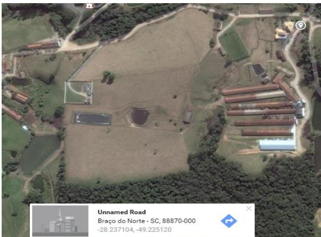
Conforme descrito na seção de dimensionamento de biodigestor presente na metodologia o volume do biodigestor modelo canadense para a propriedade 2 é de 9200 m<sup>3</sup>. O potencial de biogás foi estimado utilizando geração de biogás de 0,15 m<sup>3</sup>/animal/dia
