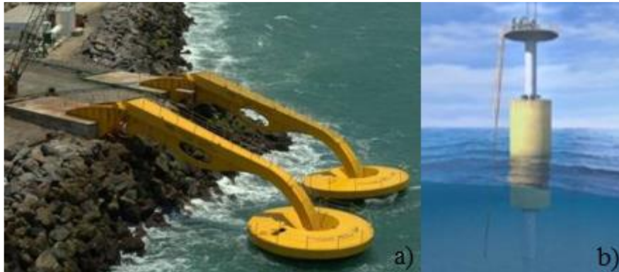
Figura 2 – Dispositivos para conversão de energia das ondas: a) Usina do Porto do Pecém (Fonte: SILVA, 2012). b) Conversor offshore na praia de Copacabana (Fonte: COPPE/UFRJ, 2013).
