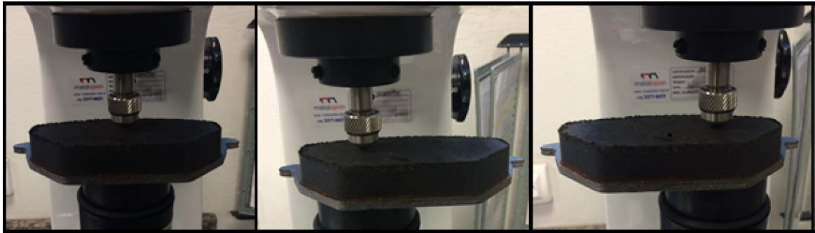
Figura 36. Posições de medição de Dureza Rockwell nas Pastilhas.
