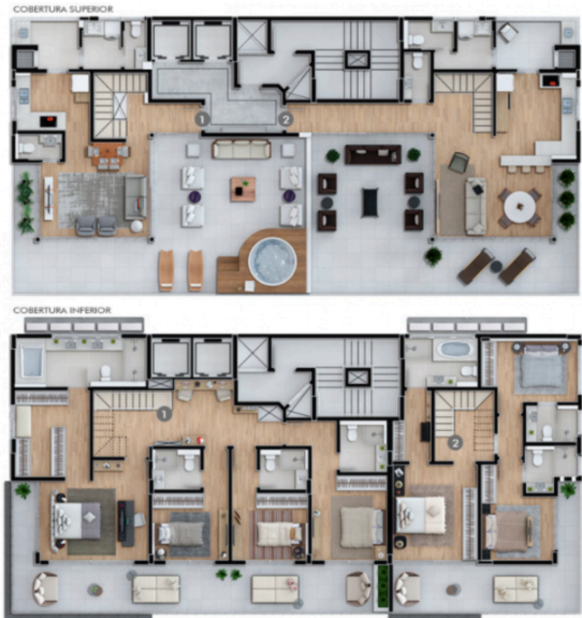
Figura 13 - Planta baixa pavimento cobertura
