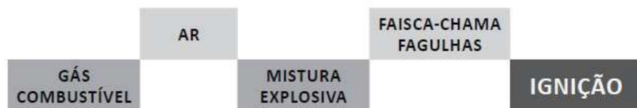
FIGURA 5 - MECANISMO DE IGNIÇÃO DE COMBUSTÍVEL GASOSO
