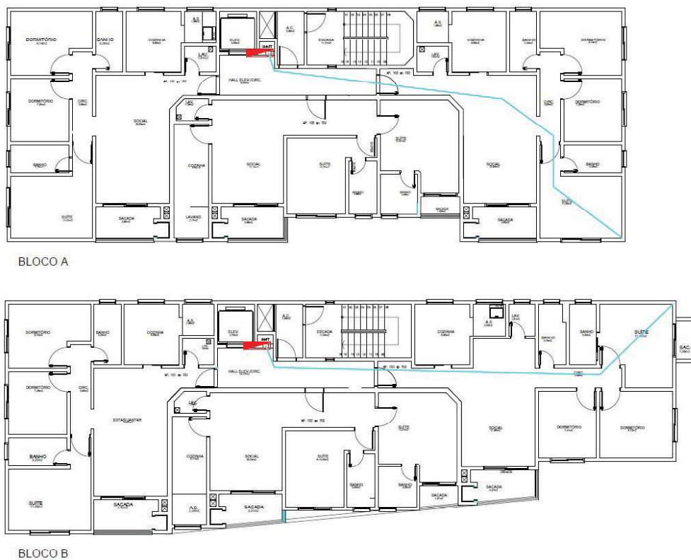
FIGURA 37 - POSIÇÃO DOS ABRIGOS DE MANGUEIRA - PAVIMENTO TIPO
