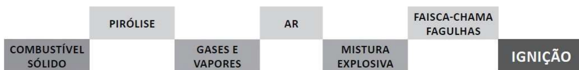
FIGURA 3 - MECANISMO DE IGNIÇÃO DE COMBUSTÍVEL SÓLIDO
