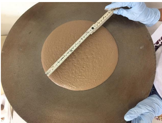
Figura 10 – Diâmetro de espalhamento da argamassa de referência
