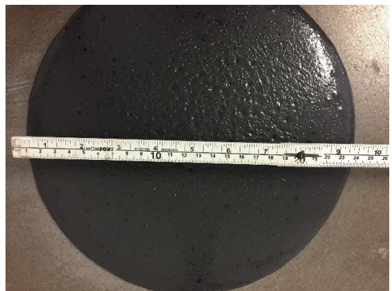
Figura 11 – Diâmetro de espalhamento da argamassa de com 25% de CCA.
