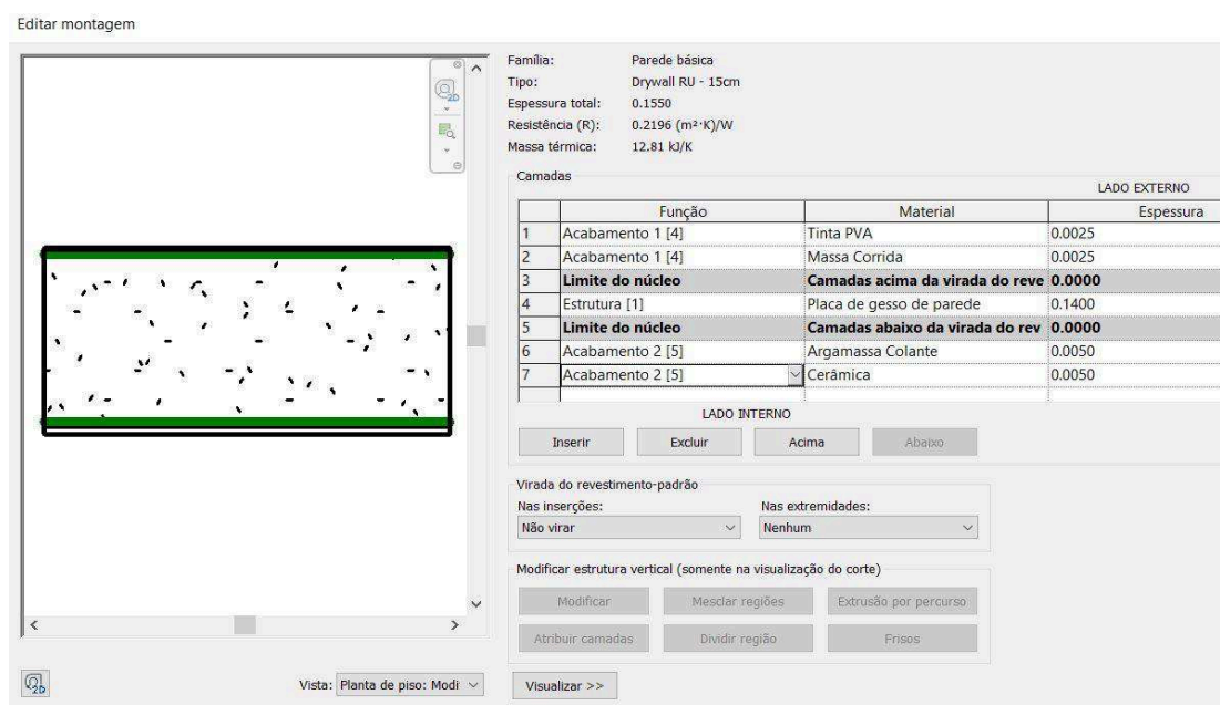
Figura 5 – Composição de elemento – parede drywall resistente à umidade
