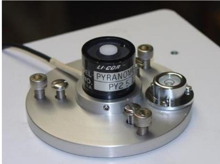
**Figura 2** - Piranômetro Fotovoltaico.
