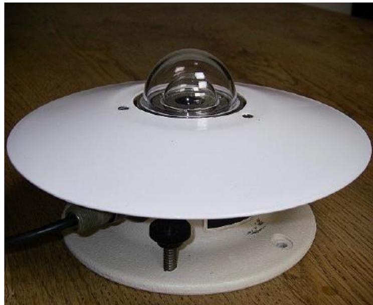
**Figura 1** - Piranômetro Termossolar.
