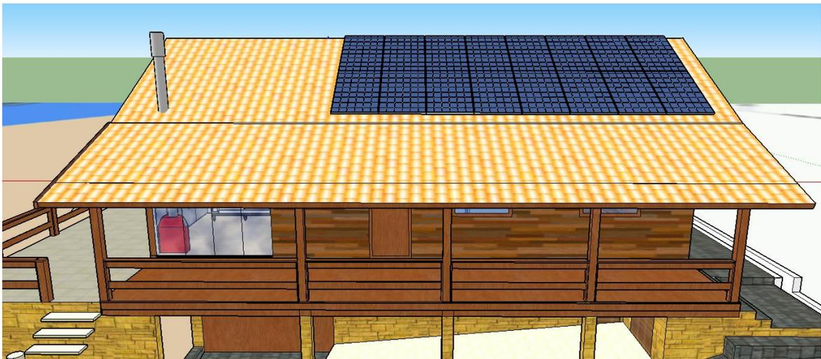
**Figura 37** – Posicionamento dos módulos FV no telhado.
