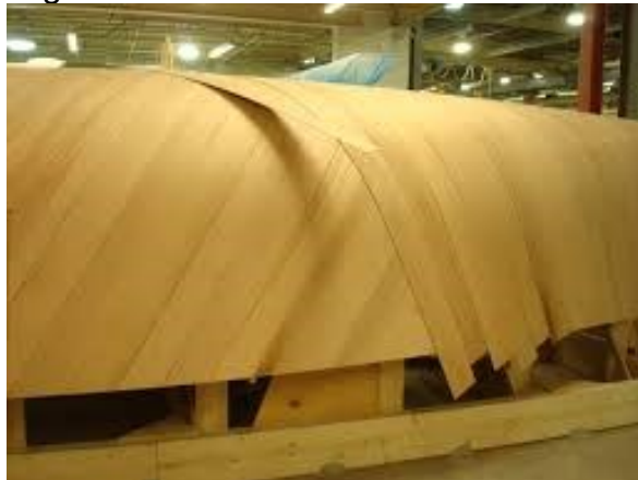
Figura 15 - Processo laminado moldado.
