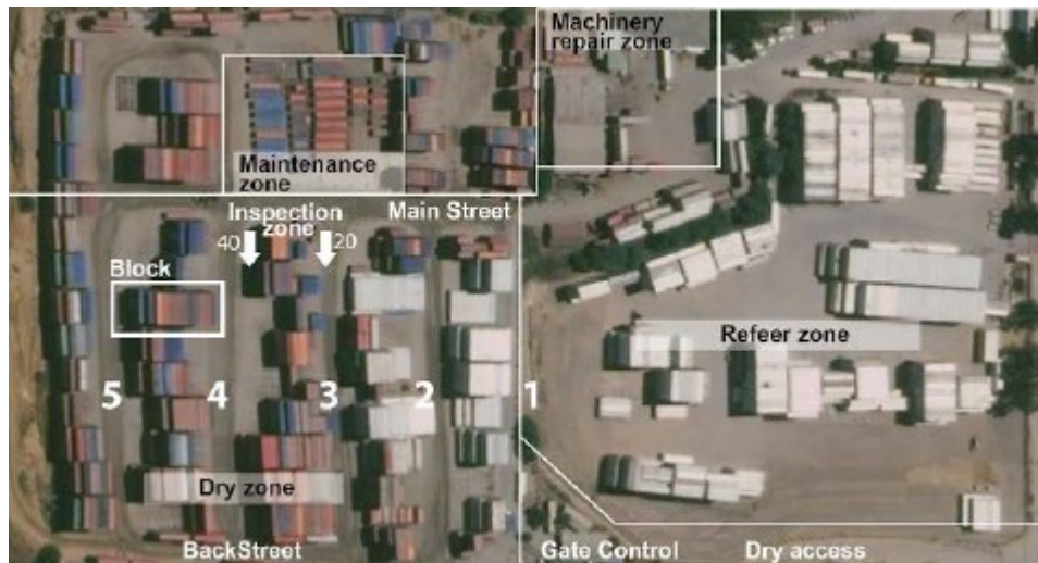
Figura 10 - Layout de um Depósito de Contêineres
