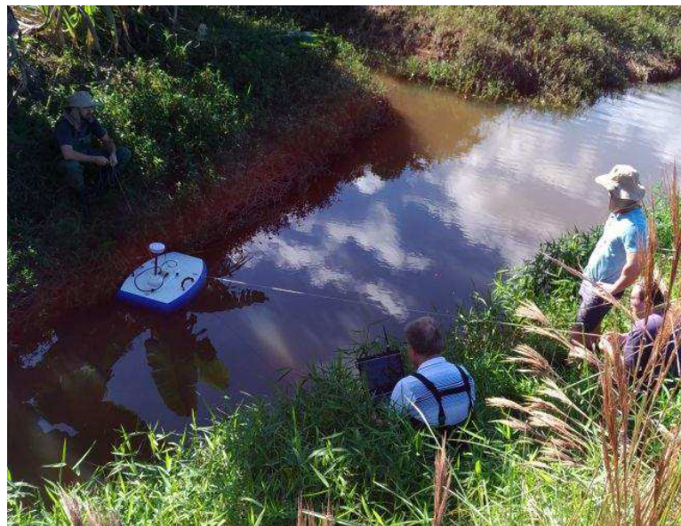
Figura 12 – Medição de vazão com ADCP
