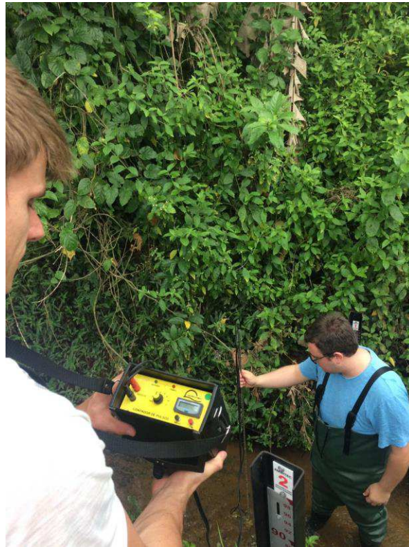
Figura 7- Medição de velocidade com uso do Micro molinete
