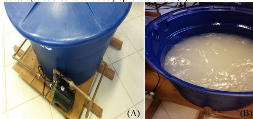
Figura 3.4 - Sistema utilizado para o preparo da água de estudo (A) e recirculação do efluente dentro do próprio reservatório (B).
