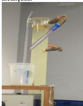
Figura 4.13 - Momento no qual a perda de carga máxima no filtro de 0,87 m foi alcançada.
