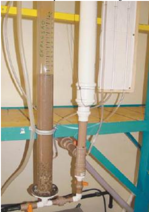
Figura 3.3 – Vista parcial do sistema piloto utilizado para a análise de expansão da areia durante o processo de retrolavagem.
