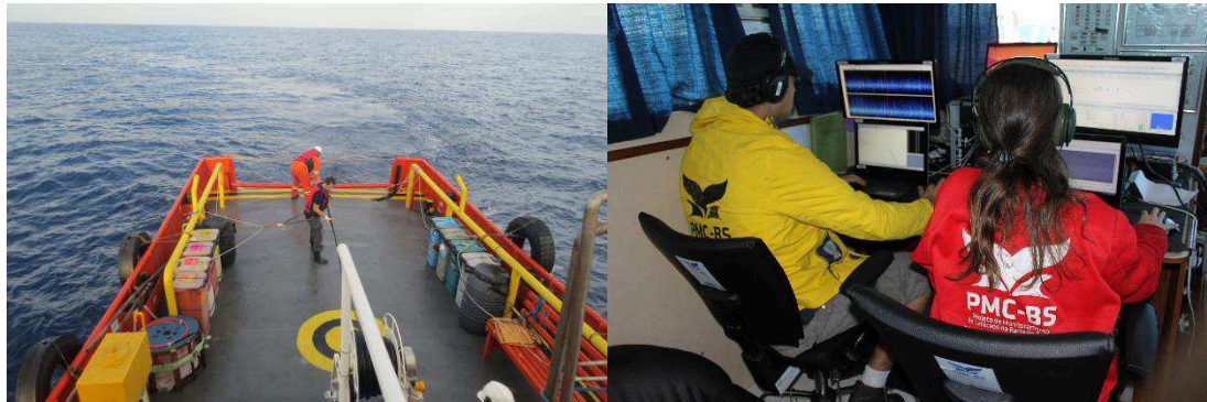
Figura 3 – Rebocamento dos cabos com hidrofones (esquerda) e operadores processando os sinais acústicos recebidos (direita).
