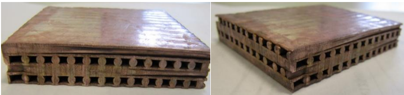
Fig. 7: Núcleo produzido usando fios de seção transversal circular [6].
