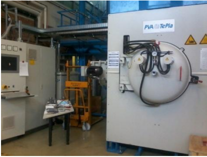
Fig. 41: Forno de soldagem por difusão do Centro de Pesquisas de Jülich.
