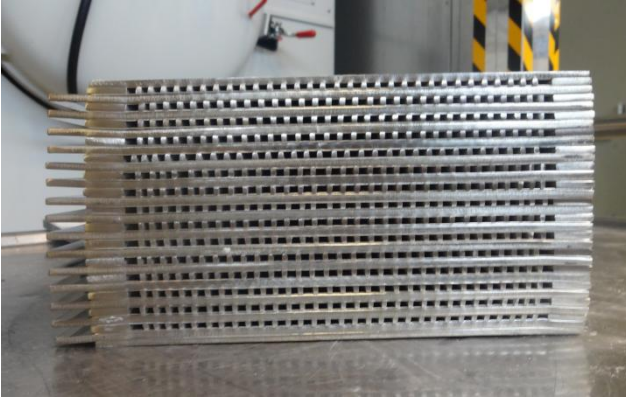
Fig. 81: Núcleo do trocador de calor após a soldagem.
