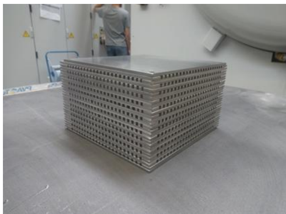
Fig. 61: Protótipo após a soldagem.
