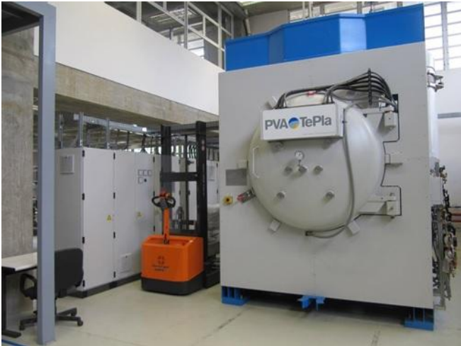
Fig. 59: Forno de soldagem por difusão instalado no LABTUCAL.
