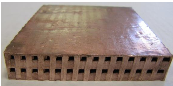
Fig. 9: Núcleo produzido usando fios de seção transversal quadrada [6].
