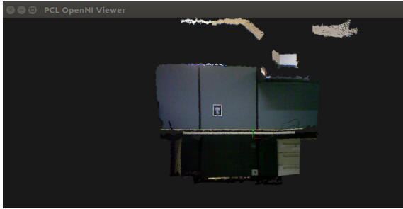
Figura 16 – Nuvem de pontos obtida pelo sensor Kinect com auxílio da biblioteca PCL
