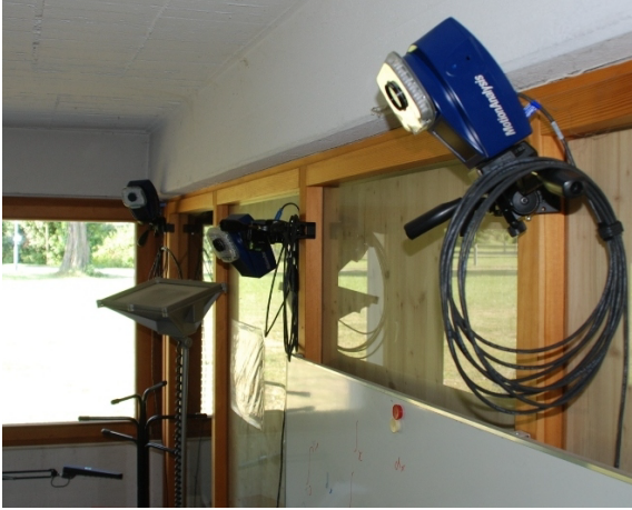
Figura 21 – Sistema de captura de movimento MotionAnalysis usado para rastrear a pose da câmera do Kinect (STURM et al., 2012)
