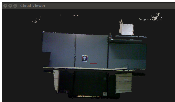
Figura 35 – Alinhamento final ICP entre duas nuvens após SAC-IA
