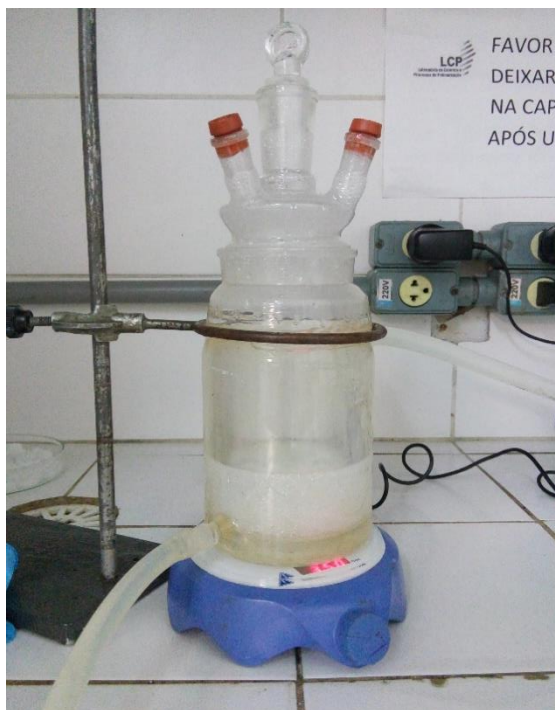
Figura 9 – Reator encamisado utilizado na etapa de polimerização das partículas.
