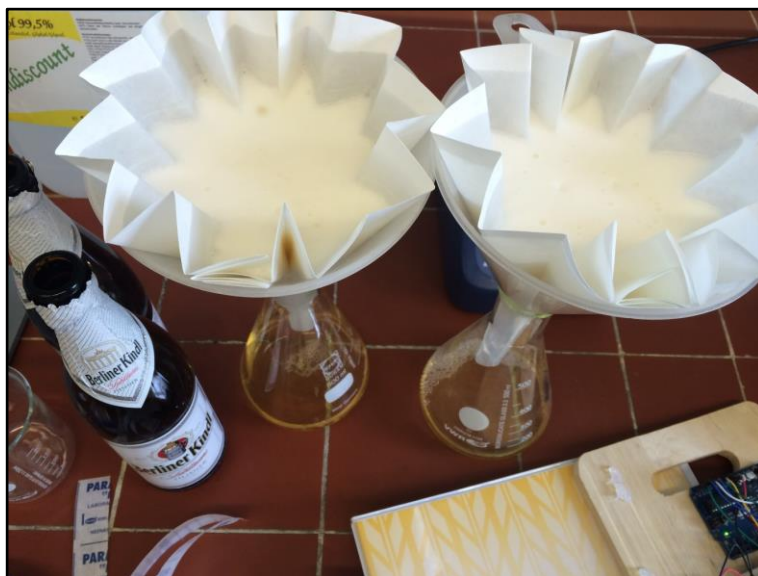
Figura 22 - Decarbonatação das cervejas para leitura em protótipo
