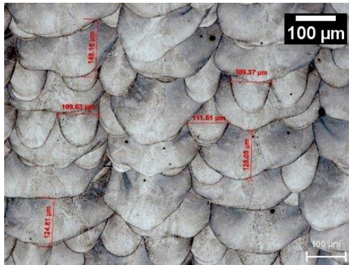
Figura 38 – Filetes da amostra como-fabricada FSL, polida e atacada com Nital 7%. Ampliação aprox. 100X.
