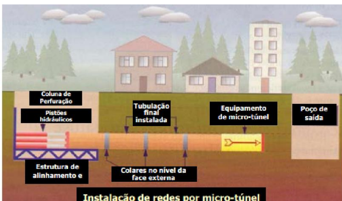
Figura 10: Instalação de redes por micro-túnel (ABRATT, 2004).
