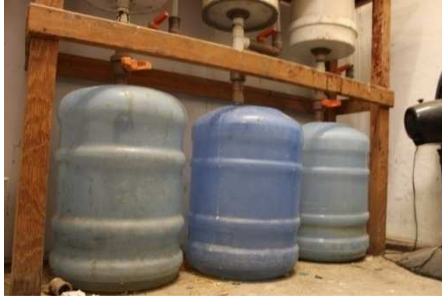
Figura 14 - Uso de válvulas e torneiras para coleta de lixiviado
