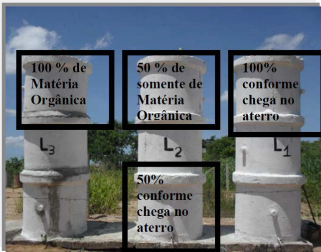
Figura 8 - Reatores construídos em concreto
