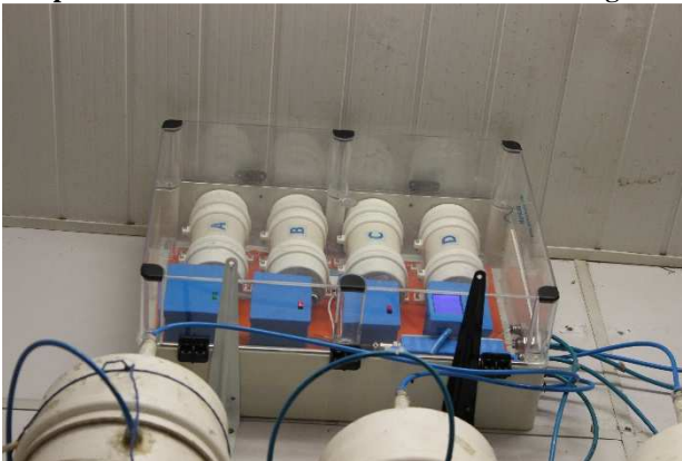
Figura 17 - Aparelho de leitura da massa acumulada de biogás
