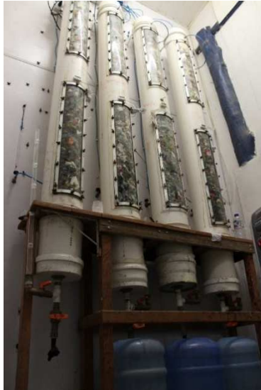
Figura 12 - Reatores simuladores de aterros sanitário (Lisímetros)
