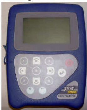
Figura 18 - Aparelho GEM2000 para leitura da composição do biogás
