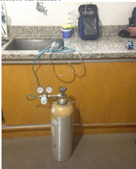
Figura 19 - Procedimento para verificação da concentração de gases conhecidos em cilindro
