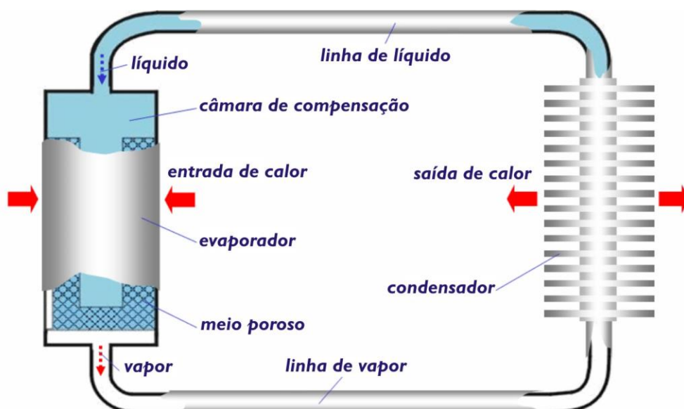
Figura 5: Esquema de um tubo de calor em circuito.
