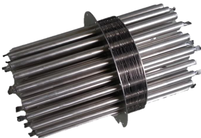
Figura 17: Trocador com termossifões carregados com sódio e um termossifão em teste.
