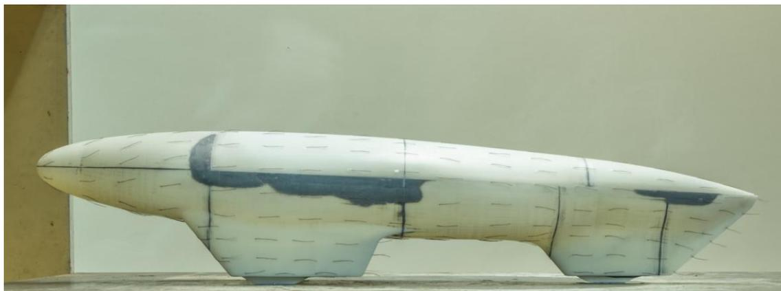
Figura 6 – Modelo em escala reduzida do Carro da E3 para ensaio em túnel de vento
