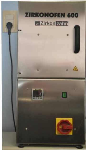
Fig. 6. Forno utilizado para a sinterização das amostras do teste piloto e da fase experimental (N5 Zirkonzahn).
