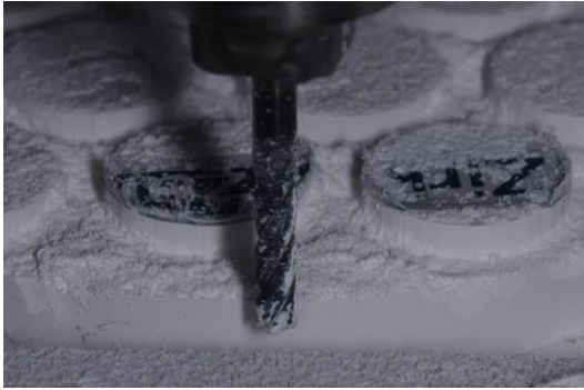
Fig.13. Imagem dos discos sendo preparados no equipamento de usinagem (Modelo MDX-40 Milling Machine - Roland, Japão).
