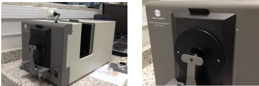
Fig.9. Espectrofotômetro utilizado para as mensurações de cor - sistema CIELAB.
