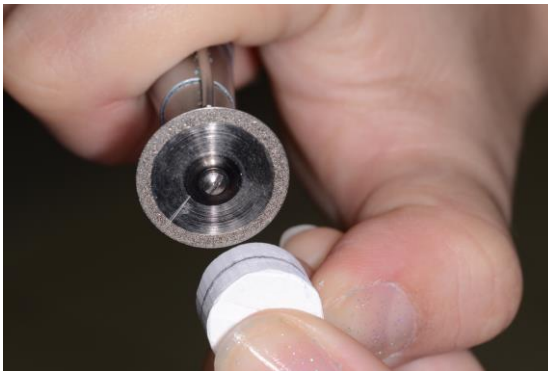
Fig.14. Cada um dos 19 discos foi mensurado com o auxílio de um paquímetro digital (Mitutoyo, Japão) na altura de 4.5mm de espessura e cortado com o auxílio de um disco diamantado (KG Sorensen, Cotia, São Paulo) acoplado a uma peça de mão. Após essa etapa os discos foram lixados com lixas de papel (até 2000) até obter a espessura de 2.5mm e polimento foi feito em ambos os lados.
