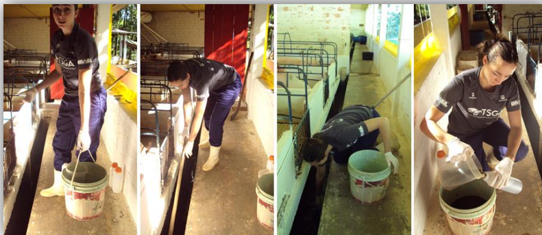
Figura 22: Procedimento de amostragem dos dejetos em uma canaleta interna.
