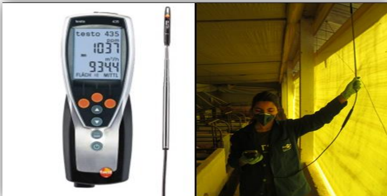
Figura 27: Equipamento multifunção, marca Testo ® , modelo 435 para procedimento de medição pontual das características do ambiente (temperatura, umidade relativa e velocidade do ar).
