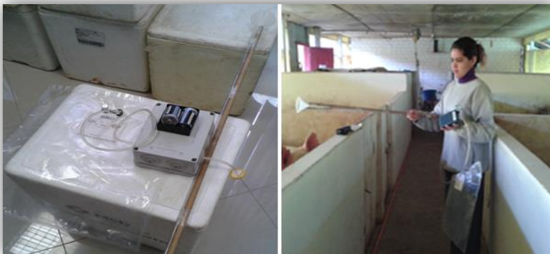
Figura 23: Equipamentos e procedimento utilizado na amostragem de ar.
