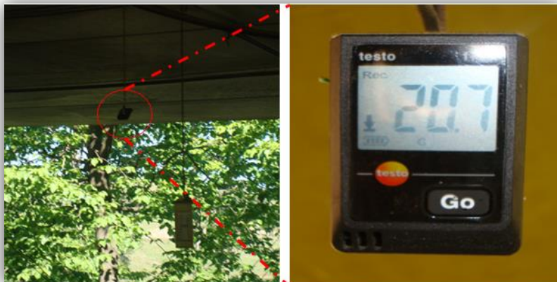
Figura 26: "Data-logger", marca Testo®, modelo 174H, instalado no interior de um edifício de alojamento para mensuração contínua das características do ambiente.
