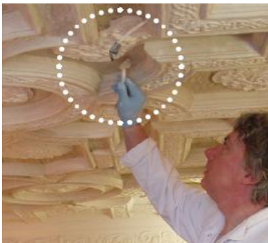
Figura 35: Sistema de amostragem de ar com mínima interferência no ambiente
