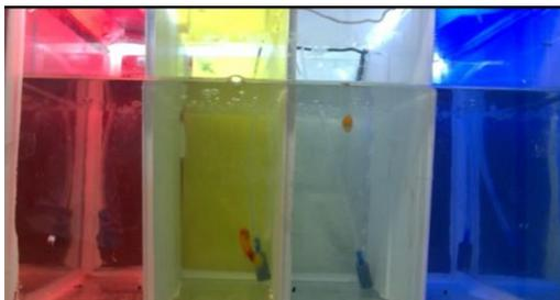
**Figura 5:** Visão frontal do aquário, com o corredor e 4 compartimentos coloridos, cada qual com aeração. As dimensões do aquário são: 40 cm de largura, 25 cm de comprimento e 30 cm de altura (25 cm de coluna de água).
