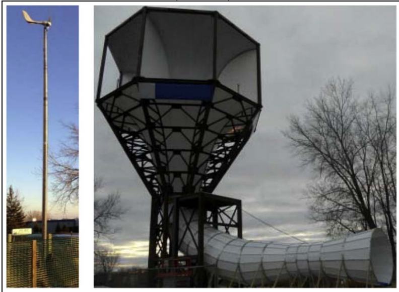
Figura 32 – Equipamentos utilizados na coleta de dados e comparação: Torre Eólica Geradora (à esquerda) e dispositivo TEC (à direita)
