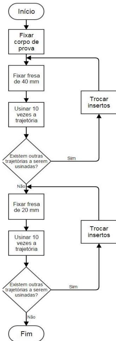
Figura 37 - Sequência de etapas adotada para realizar os ensaios
