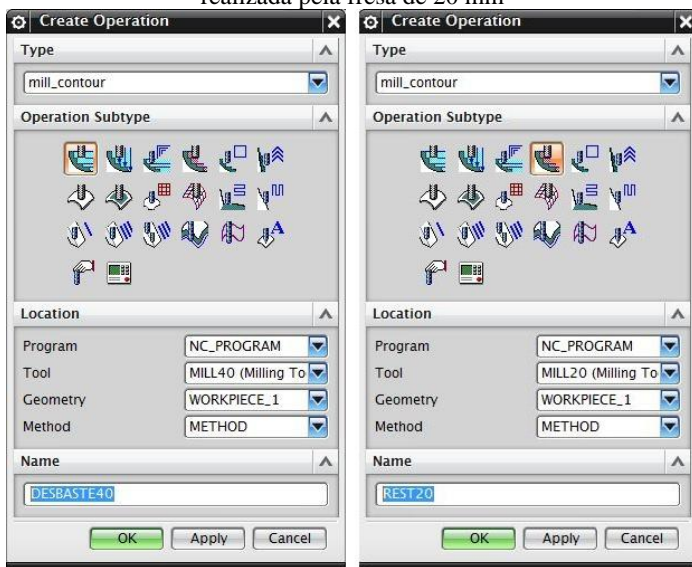
Figura B. 1 - Definição da operação: (a) realizada pela fresa de 40 mm, e (b) realizada pela fresa de 20 mm
