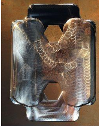
Figura 53 - Áreas fresadas com a fresa de 40 mm de diâmetro usinadas por cada ferramenta durante os ensaios (região mais profunda) e pela fresa de 20 mm de diâmetro em trajetória trocoidal
