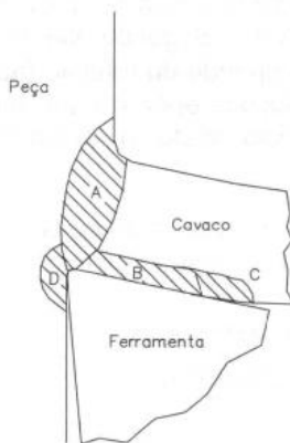
Figura 9 - Regiões em que o calor é gerado na usinagem.
