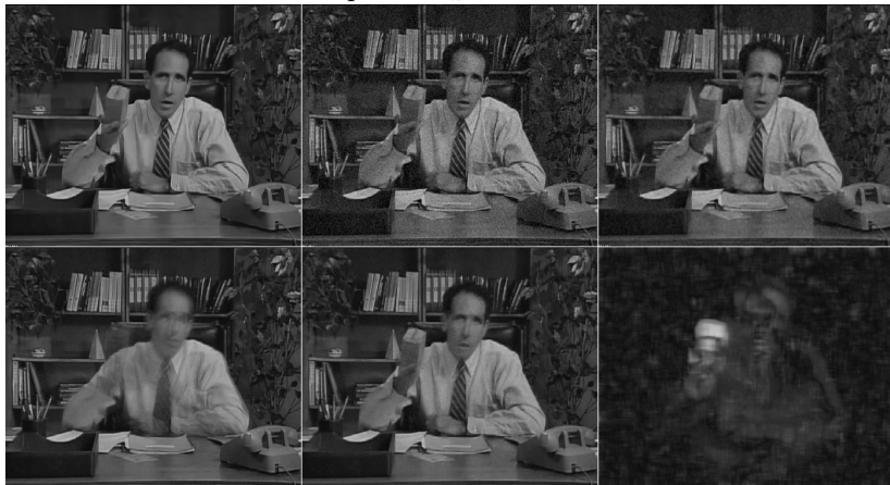
Figura 25 – Resultados do STMKF para a sequência Salesman com ruído Gaussiano com desvio padrão \sigma = 10 . Topo: frame original, frame com ruído e frame com filtro bilateral. Base: frame com o filtro de Kalman, frame com STMKF e o mapa de K_k
