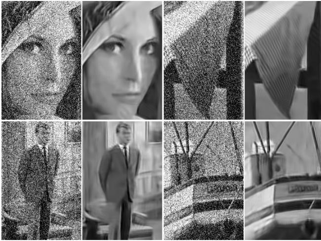
Figura 16 – Fragmentos de imagens com ruído gaussiano ( \sigma = 50 ) e o resultado do filtro baseado em block-matching .
