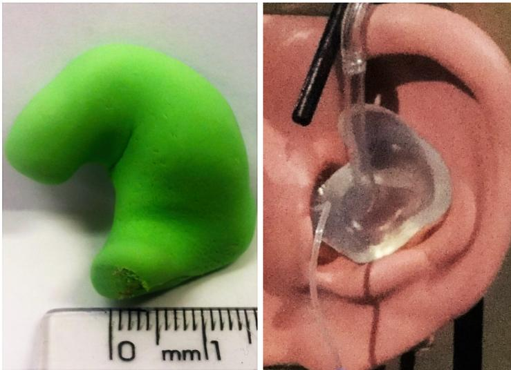
(a) Impressão utilizada no molde. (b) Molde na orelha do KEMAR.
