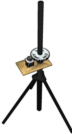
Figura 3.7 – Esquema do dispositivo de movimentação angular desenvolvido.
