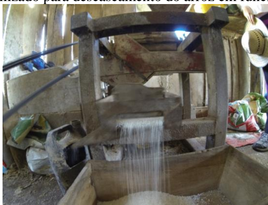
Figura 9: pilão mecanizado utilizado para descascamento do arroz em funcionamento.
