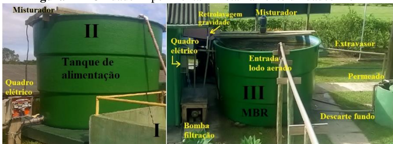
Figura 11 - Unidade Experimental - Detalhamento unidades II e III
